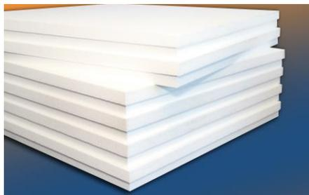
Zum Einsatz im Flachdachbereich eine druckbelastbare Wärmedämmplatte aus expandiertem Polystyrol (EPS-Hartschaum) mit einer Wärmeleitfähigkeit  $\lambda = 0,035 \text{ W/(mK)}$  und umlaufenden Stufenfalz zur Vermeidung von Wärmebrücken.
